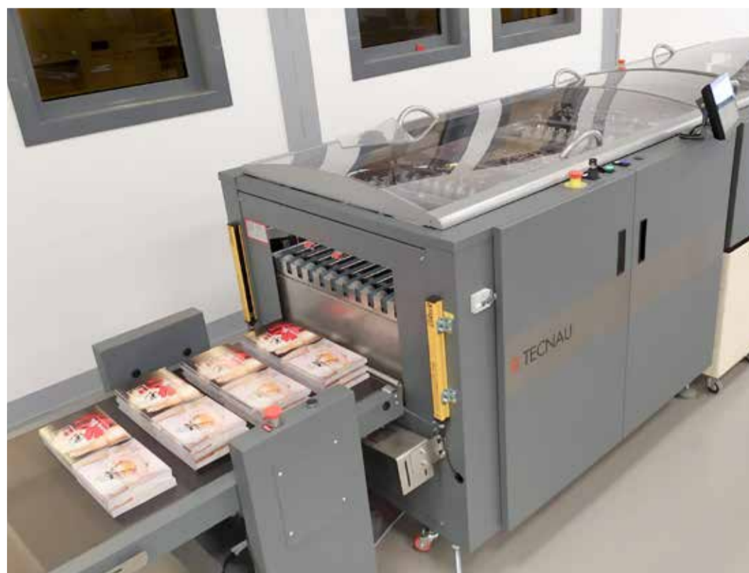
↑ Tecnau Stack 1212 umí nařezané listy přesně zarovnat a vyřadit do stohů od 1 do 21 pozic.
